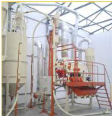
Узлы обогащения круп УОК-1 и УОК-2 предназначены для отделения трудноотделимых примесей в крупах, а также для подготовки семенного материала. Узлы обогащения круп состоят из вибропневмостола СПС с собственной металлоконструкцией, аспирацией, электрической частью и автоматикой.
