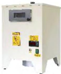
Сушильный шкаф СЭШ-ЗМУ предназначен для просушивания зерна, зернопродуктов, семян бобовых и масличных культур, а также других влагосодержащих веществ при определении влажности.
