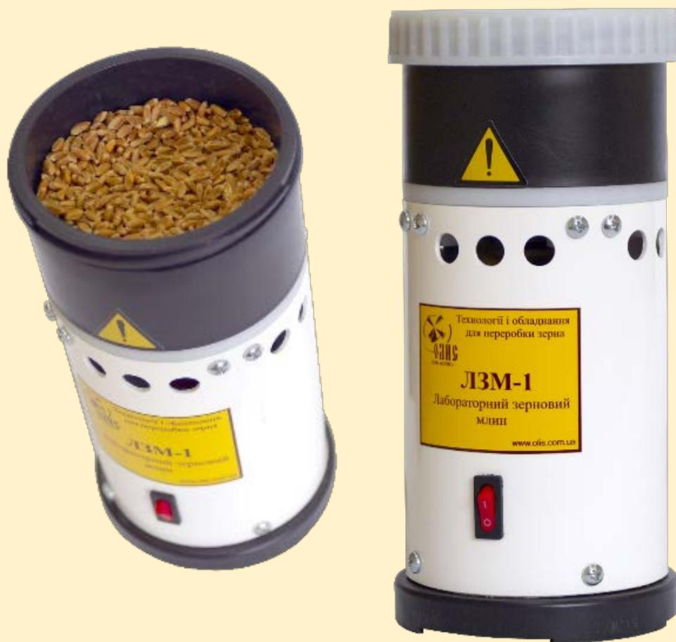
Лабораторная мельница ЛЗМ-1 предназначена для измельчения лабораторных проб зерна сельскохозяйственных культур и других твердых пищевых продуктов влажностью не выше 18% с целью подготовки для последующего определения показателей качества зерна.
