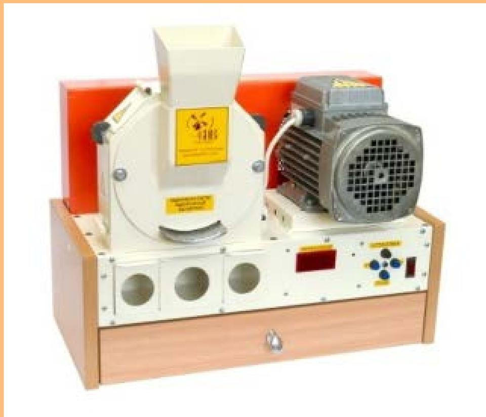
Лабораторный шелушитель УШЗ-1 применяется в научно-исследовательских лабораториях, на зернопроизводящих, хлебоприемных и перерабатывающих предприятиях для исследования процессов шелушения зерна.
