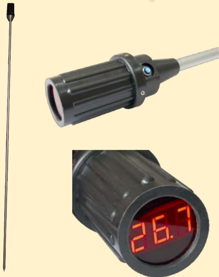
Термоштанга цифровая ТЦ предназначена для измерения температуры сыпучих материалов (зерна, комбикорма и др.), склонных к самосогреванию при хранении на складах и в зернохранилищах. Термоштанга применяется в лабораториях предприятий пищевой промышленности.
