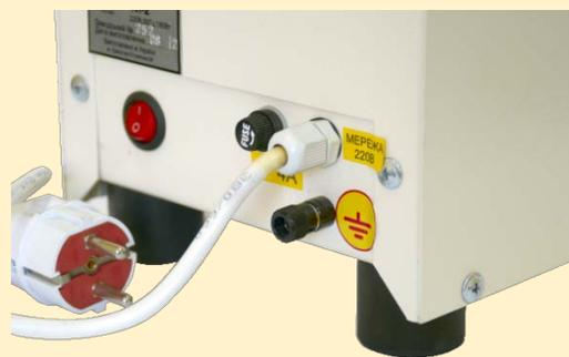
Тестомесилка ТЛ-2 предназначена для замеса теста из цельносмолотого зерна пшеницы (шрота) и муки хлебопекарного и макаронного помола при определении количества и качества клейковины. Применяется в лабораториях хлебоприемных, мукомольных, хлебопекарных предприятий, а также ГХИ и научно-исследовательских организациях.
