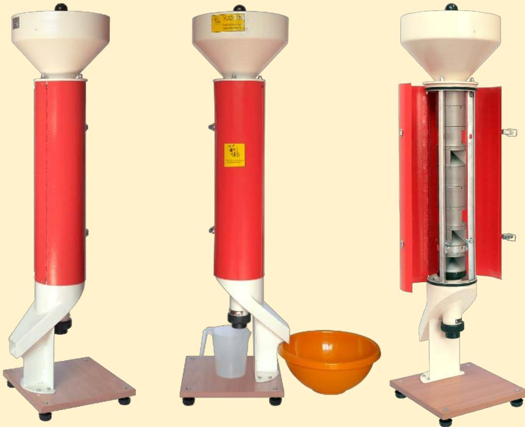
Универсальный делитель зерна УДЗ-1М предназначен для отбора навески требуемой массы из исходной пробы зерновых, масленичных, бобовых культур объемом до 8 литров методом равенства площадей в пропускном сечении прибора по проходу и сходу анализируемого продукта. Есть возможность выделить навеску 10г, что очень важно при работе с рапсом и другими мелкосеменными культурами.
