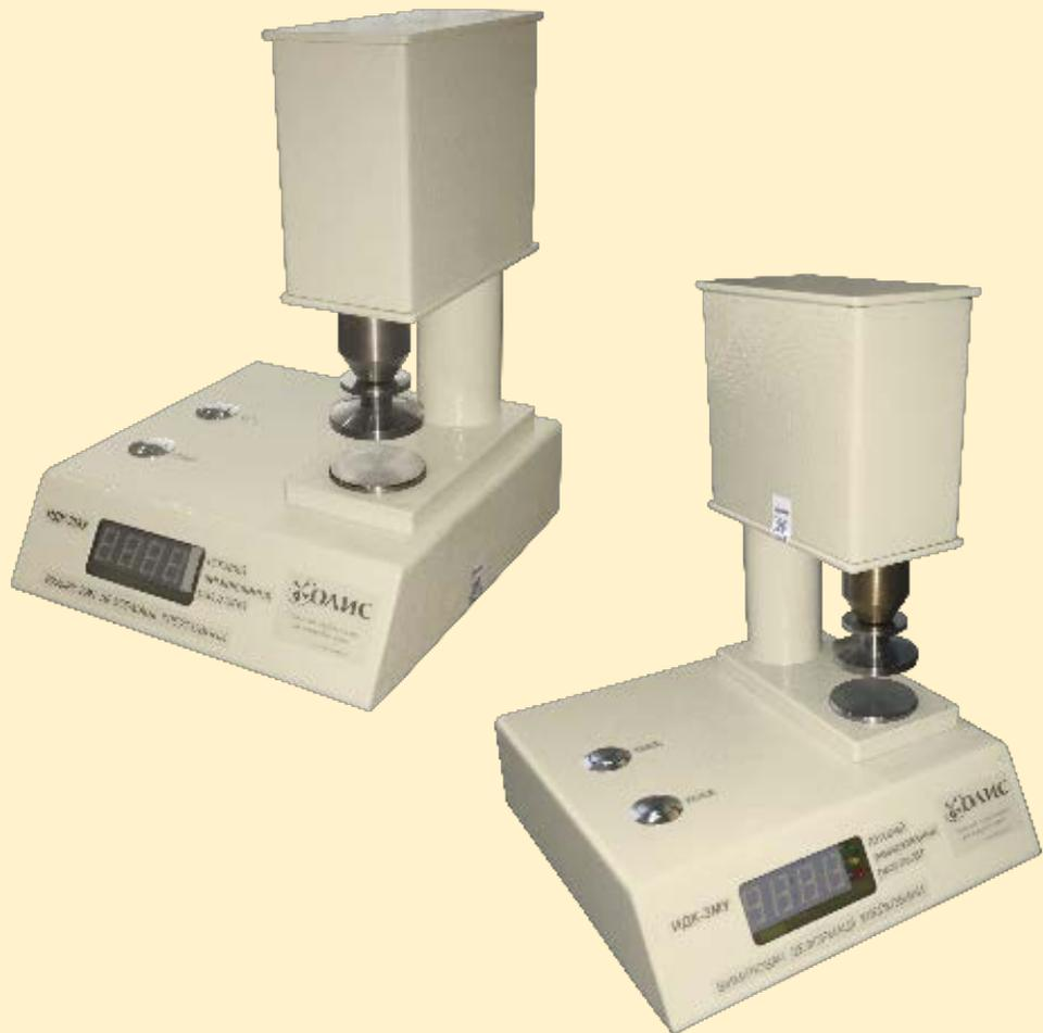
Изделие предназначено для определения качества клейковины зерна пшеницы и пшеничной муки хлебопекарного и макаронного помола по величине ее деформации под воздействием нагрузки определенной величины в течение заданного интервала времени.
