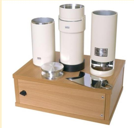
Пурка литровая с падающим грузом ПХ-2 предназначена для определения природы зерна (массы зерна в одном литре). Применяется в лабораториях зерноприемных, перерабатывающих предприятий, научно-исследовательских организациях и др.
