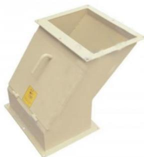
Магнитный сепаратор БМПО предназначен для выделения металломагнитных примесей (сталь, чугун) из промежуточных продуктов размола зерна. Данная машина используется на элеваторах, мукомольных, крупяных и комбикормовых заводах. Устанавливается в технологические линии после бункеров для отволаживания (дозаторов).
