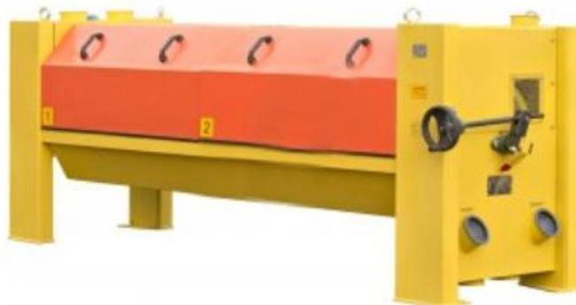
Триер-овсюгоотборник ТЦО производства ОЛИС предназначен для очистки зерна основной культуры от длинной примеси овсяга. Также используется для сортирования очищенного зерна по длине.
