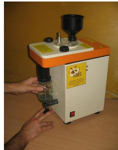
Рис.3 Установка и снятие емкости приемной
