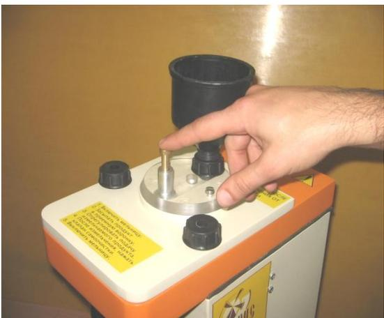
Рис. 5 Очистка камеры измельчения
